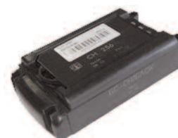
БС-СН со съёмным носителем информации СН-256
